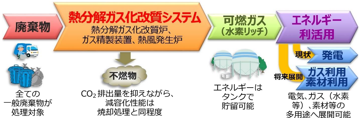
次世代廃棄物処理システムフロー
