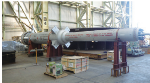
【グリーンアンモニア実証プラント用コンバーター（福島県）】
