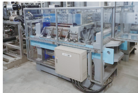
北海道電力株式会社へ納入した水素発生装置
