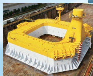
▼NEDO委託事業/ 次世代浮体式洋上風力発電 システム実証研究(バージ型)/ 実証機浮体の製作
