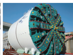
● シールド掘進機
