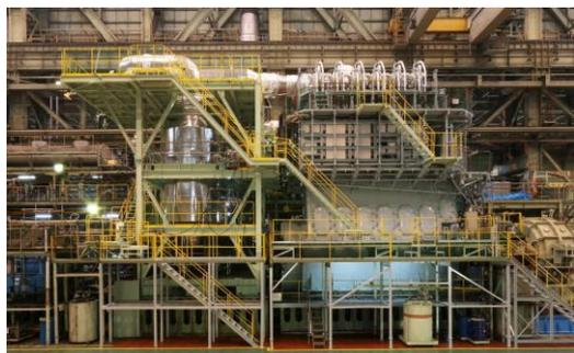
(※)船用SCR(Selective Catalytic Reduction)システム：船用原動機から排出されるNOxを触媒で除去する装置
