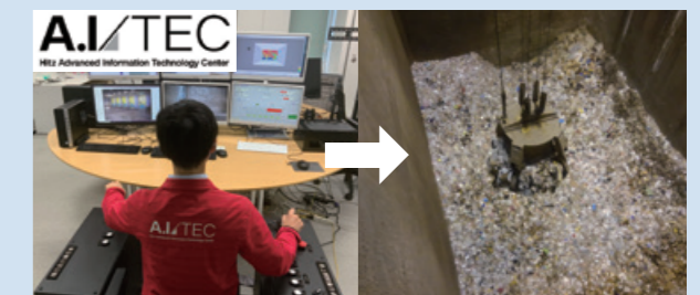
A.I./TECからごみクレーンを遠隔操作
