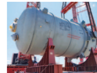
米国向けエチレンオキサイド(EO)反応器
