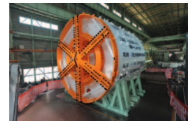
八王子南バイパス 館第一トンネル向けシールド掘進機
