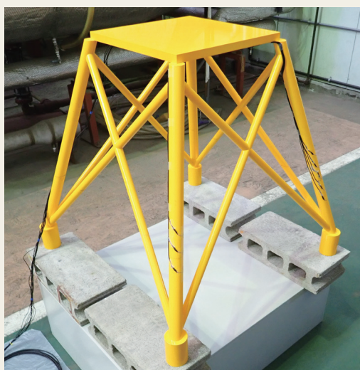
図5 ジャケットを模擬した供試模型
