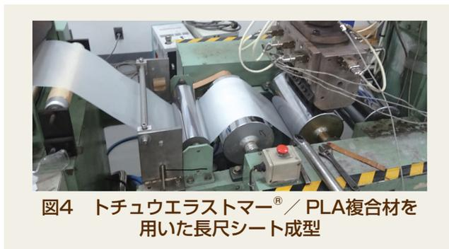
図4 トチュウエラストマー<sup>®</sup> / PLA複合材を用いた長尺シート成型
