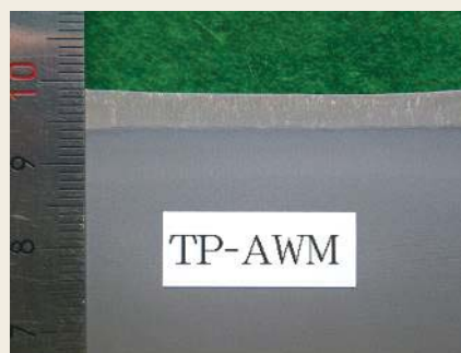
図15 ESW肉盛溶接試験片の断面マクロ
