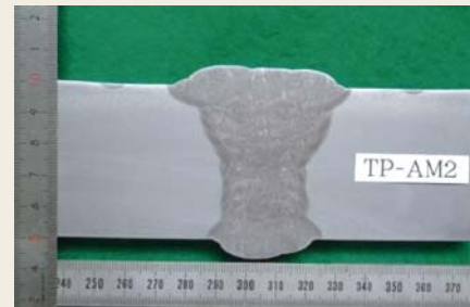
図9 SAW溶接試験片の断面マクロ
