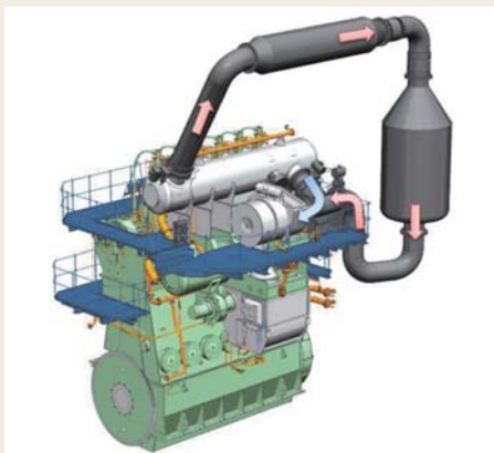
図4 SCRシステムを搭載した6S46MC-C概要
