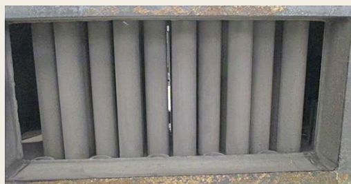
図23 NH 3 濃度5ppmで試験した際の内部状況
