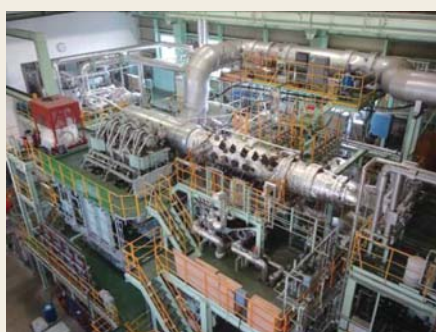
図11 4S50ME-Tおよび分離型SCRシステムの概観
