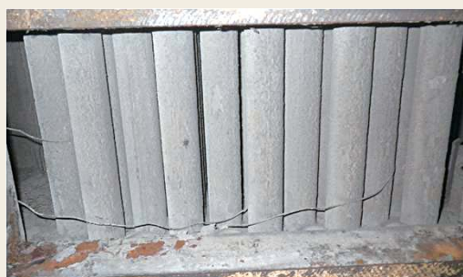
図22 NH 3 濃度80ppmで試験した際の内部状況
