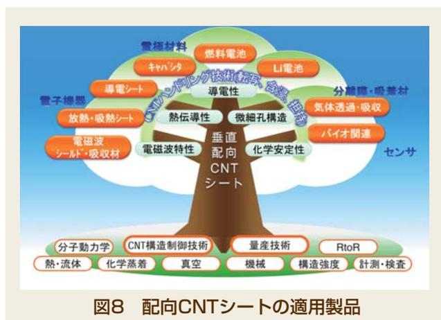
図8 配向CNTシートの適用製品
