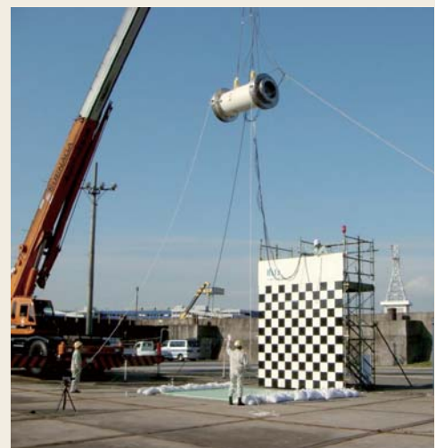
図9 9m落下試験状況(水平落下)
