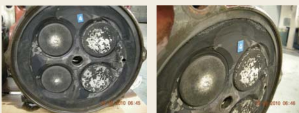
図7 高負荷運転後のシリンダヘッド
