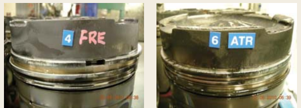
図9 高負荷運転後のピストンリング(側面)
