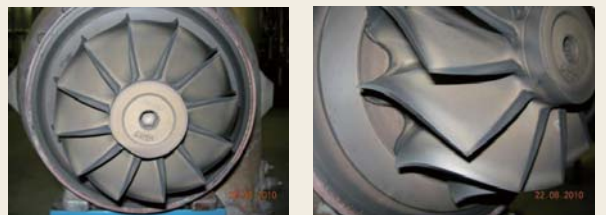
図10 高負荷運転後の過給器のロータ
