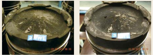
図8 高負荷運転後のピストンリング(頂面)
