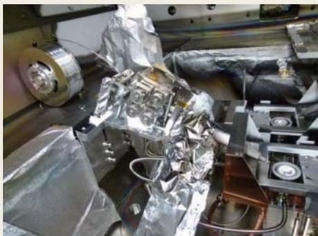
図9 RtoR装置へ搭載した材料供給機構付EB蒸着源(2基)
