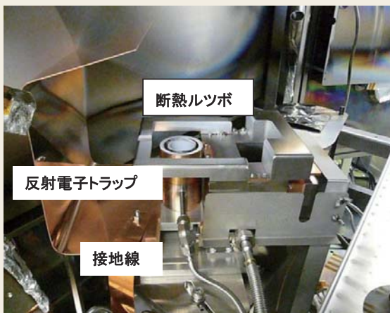
図5 EBガンに断熱ルツボと反射電子トラップを設置
