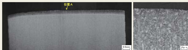
(a)マクロ組織 (b)ミクロ組織 図7 レーザ切断面の組織
