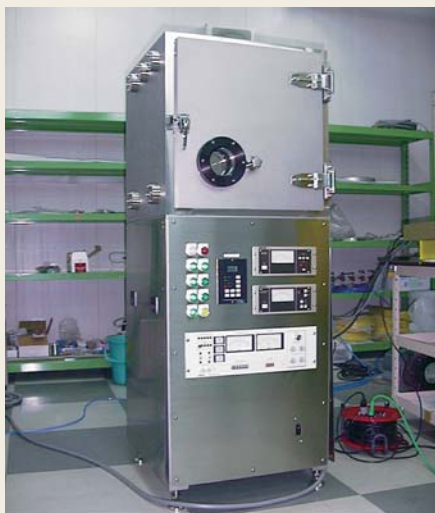
図3.2 真空スパッタ装置
