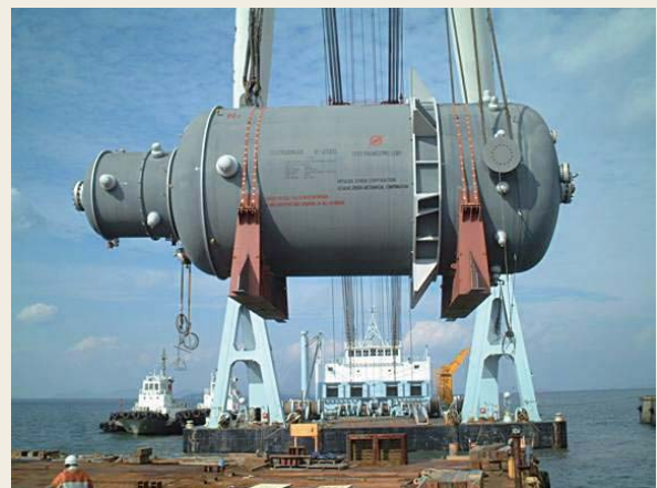
図8 堺工場組み立ての1160トンEO反応器
