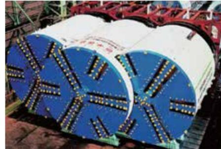
マルチフェイスシールド掘進機 Multi-Face shield tunnel boring machine
