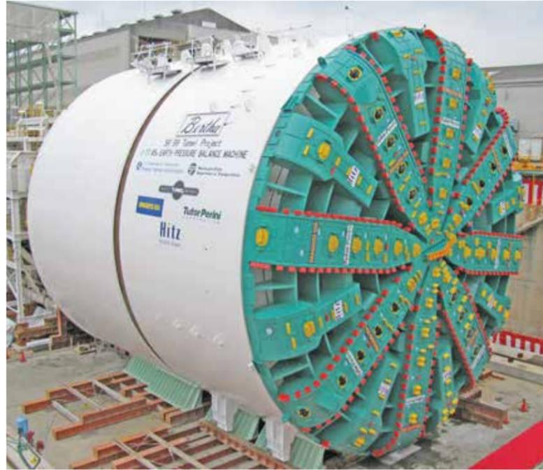
泥土圧シールド掘進機(世界最大級口径 17.45m) EPB shield tunnel boring machine (The world's largest, φ17.45m)
