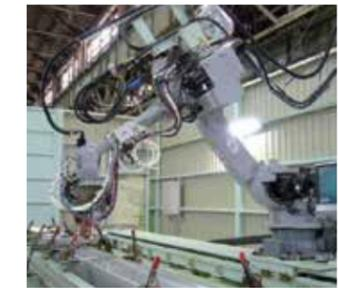
レーザー溶接機 (10kW)
