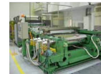
フィルム・シート押出成形テスト機 Film and sheet extruding and forming test machines
