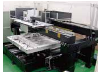
レーザー加工装置 Laser patterning equipment
